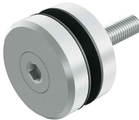
Conector muro a vidrio para cristal templado. Instalación en el vidrio con barreno de 14mm ó sin él, sujetando la carga con el tornillo del centro. \*Anclar a muro con taquete expansivo.
