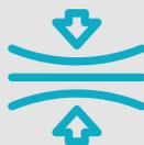
Los paneles alveolares Glanze pueden ser perfectamente curvados en frío en dirección longitudinal. Los radios de curvatura varían entre 750 y 1500 mm, según el espesor del panel. La diversidad de los paneles alveolares Glanze las hacen idóneas para aplicaciones curvas o planas. Su excelente resistencia a la deformación bajo carga en condiciones adversas, le permite mantenerse estable sin que se perciban deformaciones importantes que perjudiquen el desempeño y presentación del producto.
