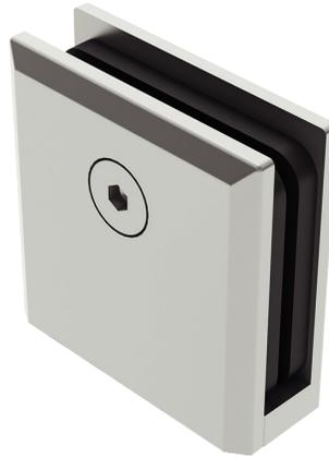
Conector con base mediana y dos tornillos de fijación. La instalación del vidrio queda a paño. Se recomienda instalar un conector cada 1.50m de separación máxima. \*Anclar a piso ó muro con taquete expansivo.
