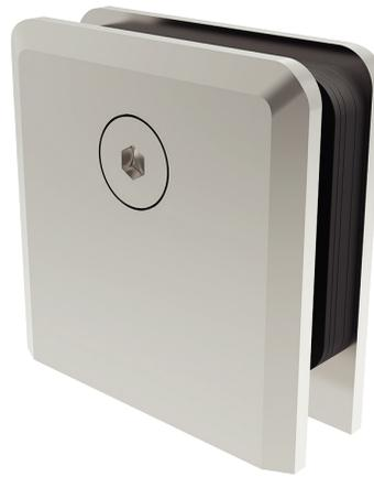
Conector con base chica y un tornillo de fijación. La instalación del vidrio queda a paño. Se recomienda instalar un conector cada 1.50m de separación máxima. \*Anclar a piso ó muro con taquete expansivo.
