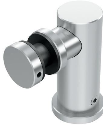
Conector pipeta muro a vidrio para perforación redonda ó recta en cristal templado. Instalar un conector cada 1.50m de separación máximo, y en caso de que el cristal supere 1m de altura, instalar conectores en la parte superior ó en los laterales. \*Anclar a piso ó muro con taquete expansivo y pija.
