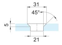
NOTA: Para la ubicación de los barrenos avellanados se usa la misma fórmula que en los barrenos para el accesorio 2214.
