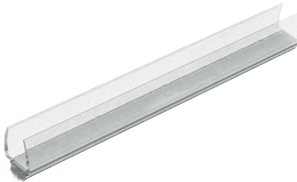
Perfil de policarbonato tipo "U" con portafelpa para puerta batiente. Cuenta con 2.50m de largo y es para cristal de 9mm de espesor.
