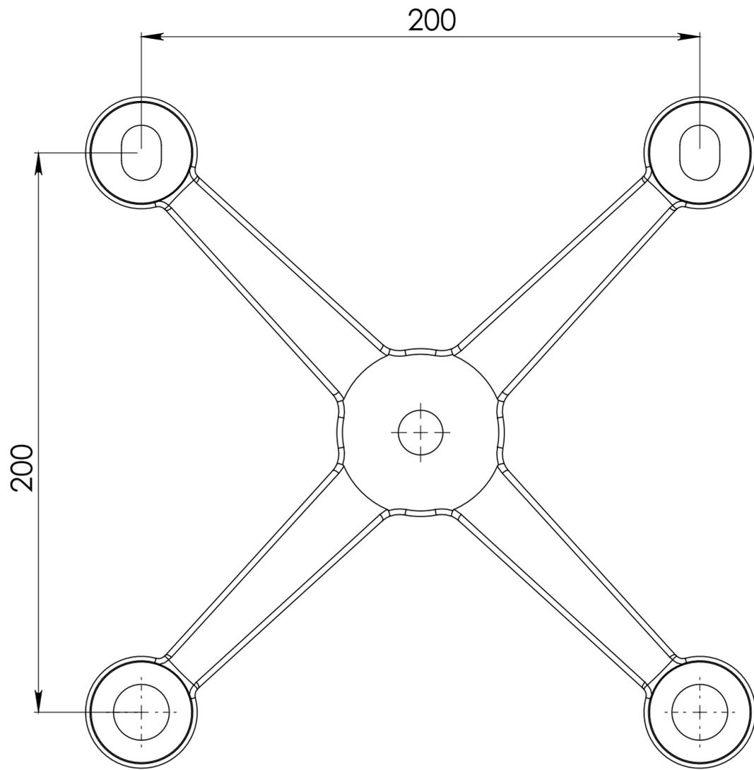
**PARA DETERMINAR LA POSICIÓN DE LOS BARRENOS EN EL VIDRIO**
