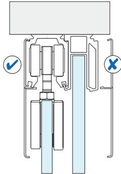
\*El perfil tapa lateral solamente se instala con el riel 2200300 / 500NA y utilizando la carretilla 1200000CA
