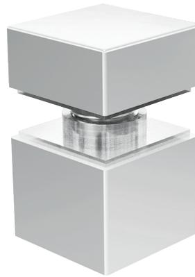
Conector cuadrado muro a vidrio templado, de 20x16mm y 9mm de espesor, perforación en vidrio de 12.7 mm (1/2"). Instalar a 1.5m de separación máximo. Fijar a muro con taquete expansivo.
