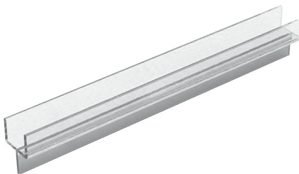
Perfil de policarbonato Xochimilco tipo sellapolvo con aleta central flexible, para vidrio de 9mm de espesor y con largo de 2.50m. \*Puede ser instalado hacia el piso.
