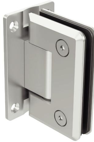
Bisagra Tlaquepaque muro a vidrio con apertura de 180° para cancel de baño con cristal templado. La bisagra cierra sola a partir de 25° en ambas direcciones.
