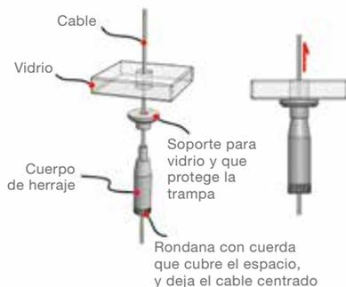
El soporte intermedio sirve para sostener cada entreaño de vidrio, su trampa regula hacia arriba y abajo para colocar cada pieza a la altura requerida.
