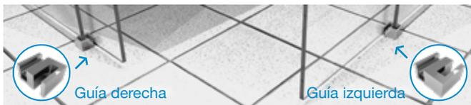
\*\*Te sugerimos que el cristal corredizo se coloque por la parte interior hacia la regadera y el fijo siempre hacia afuera, para evitar en lo posible la filtración de agua al exterior.
